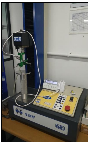
Figura 5 – Montagem do ensaio de corte axial na máquina de ensaio universal, EMIC DL 200MF, com motor endodôntico VDW silver acoplado.
