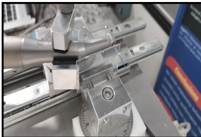
Figura 8 – Montagem do ensaio de corte lateral. Peça de mão encaixada no suporte da máquina, permitindo uma ação de 90° do instrumento na placa de plexiglass.
