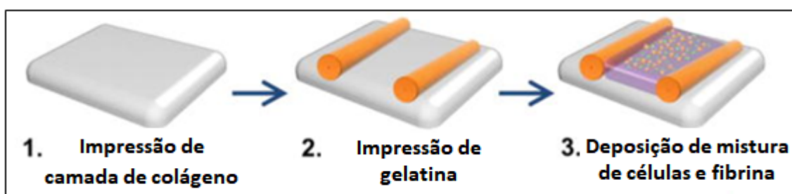
Figura 23: Exemplo de abordagem para biofabricação de uma rede vascular a partir da técnica de bioimpressão 3D por extrusão. Inicialmente, foi impressa uma camada de colágeno como substrato. Em seguida, a gelatina foi impressa nas laterais para formar um canal e por fim, foi feita a extrusão da biotinta contendo fibrina e os componentes celulares endoteliais (adaptado de LEE et al. , 2014).
