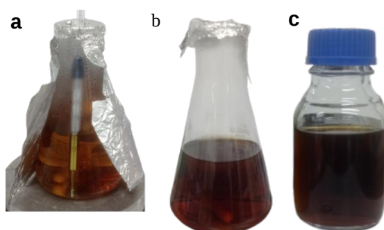
Figura 7. Primeiro lote sintetizado pelo protocolo em aquecimento. (a) Sistema em 60 °C, solução amarelo-alaranjado. (b) Final da síntese, coloração mudou para marrom-avermelhado (c) Após 35 min do fim da síntese, a coloração mudou para marrom escuro.
